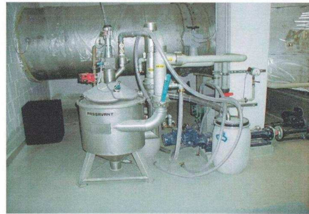
Fettabtrenner zur Entfernung und Entsorgung des ausgewaschenen Kakaofettes
