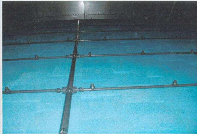
Beregnungsdüsen zum Verteilen der Nährlösung in der PU-Stufe
